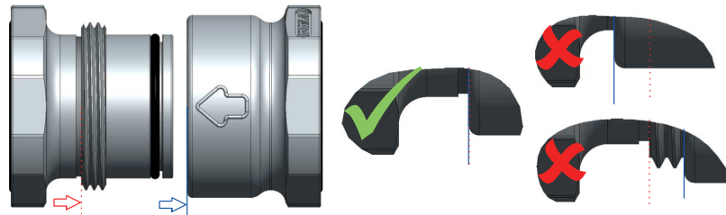
Fig. 35: Comprobar la alineación 13. Comprobar la alineación correcta.
